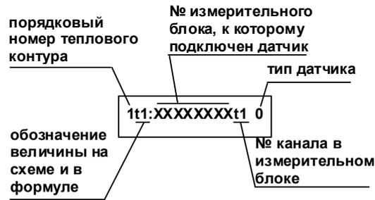
Рисунок Н.1 — Формат отображения конфигурации датчиков
